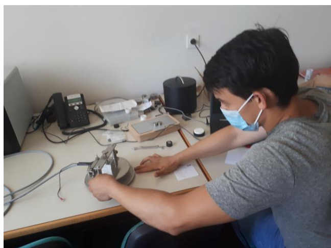
Blaž Žerjav Jereb meritvi toplotnih lastnosti na napravi HD TPS 2200.
