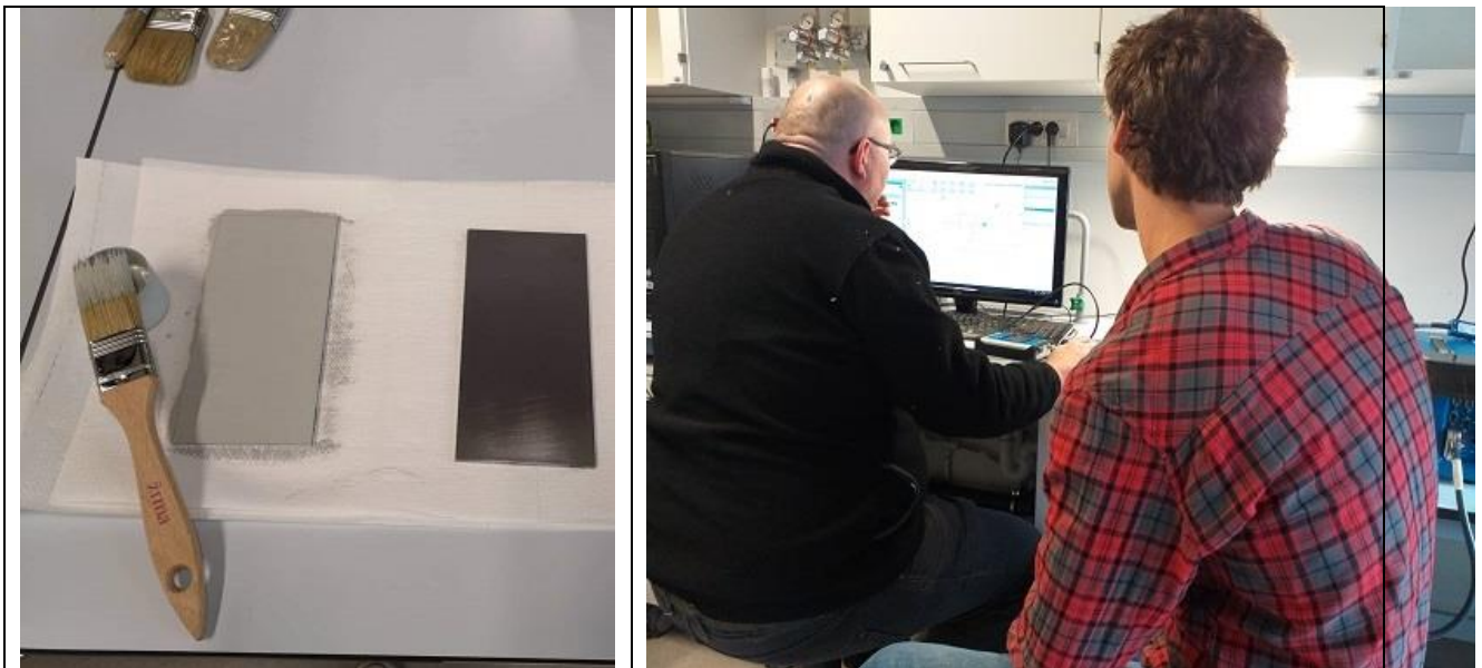
Sliki 3 in 4: Levo: nanašanje vodnega epoksi premaza na testne kovinske ploščice; desno: analiza kvalitete protikorozijske zaščite pripravljenih vodnih epoksi premazov z metodo elektrokemijske impedančne spektroskopije.
