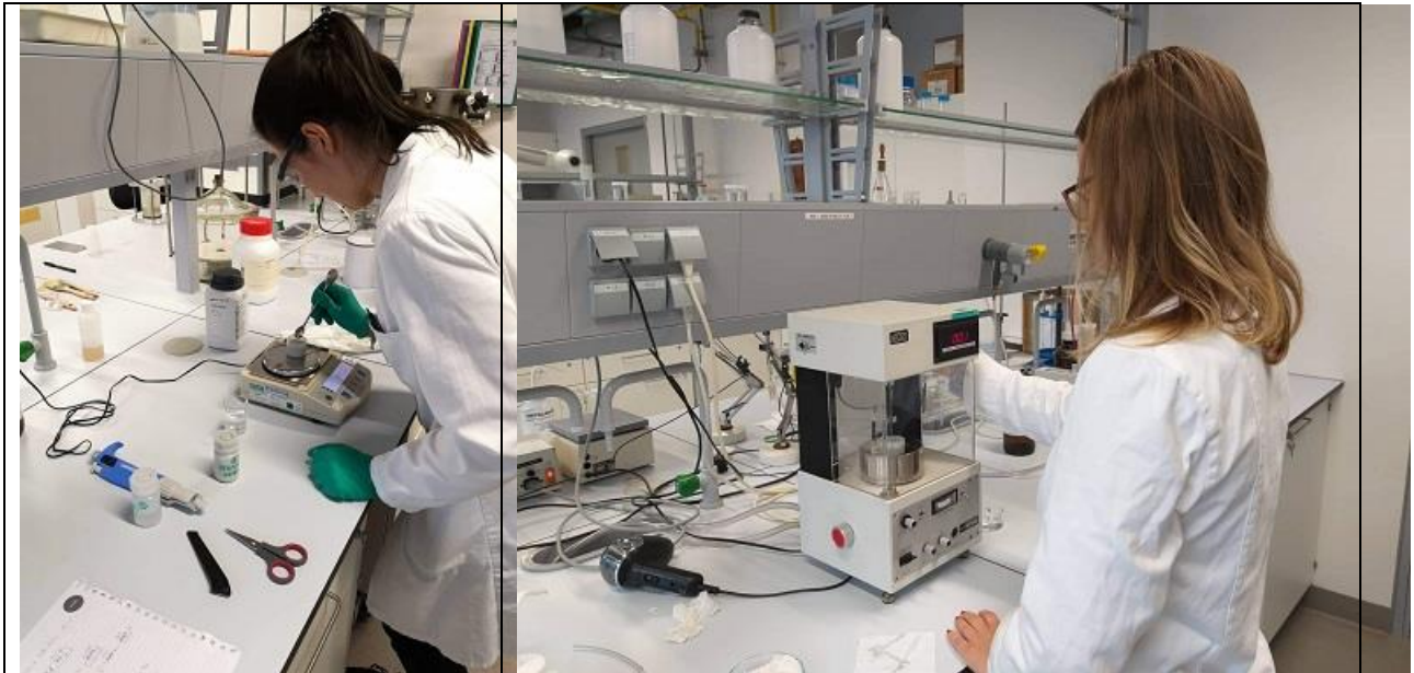
Sliki 1 in 2: Levo: mešanje vodnega epoksi premaza; desno: merjenje površinske napetosti pripravljenega vodnega epoksi premaza s tenziometrom.
